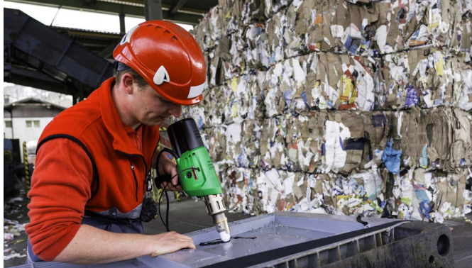
FUSION 1: naprawa pojemników transportowych.
