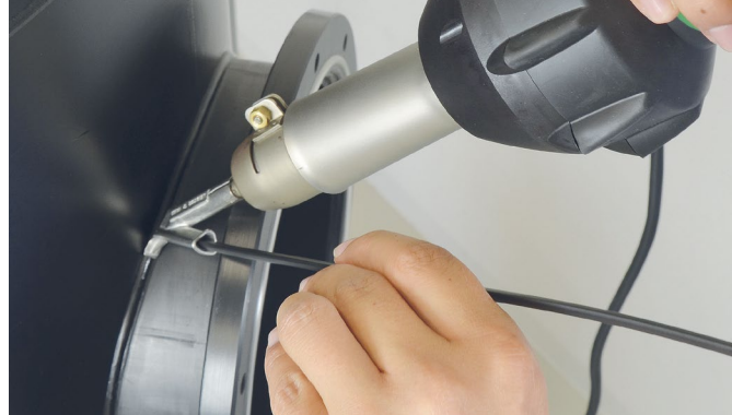
Spawanie elementu z PP
