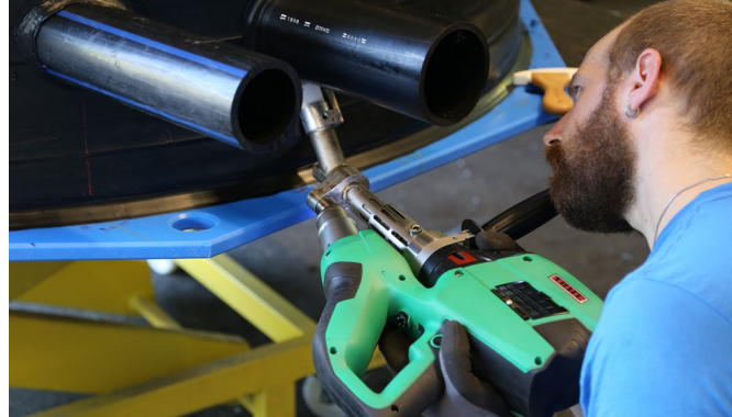
Spawanie z użyciem przedłużki kątowej 45°
