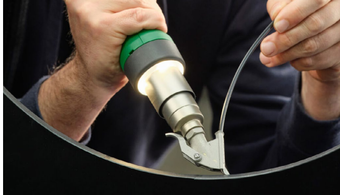
Leister PENWELD A - podświetlanie strefy spawania
