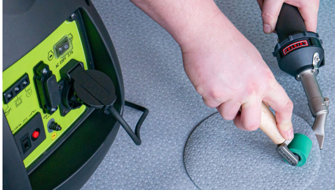
Mobilny zestaw serwisowy do zgrzewania folii dachowych, basenowych i plandek.
