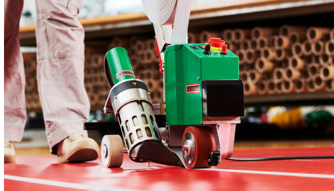
TAPEMAT - płynne sterowanie temperaturą oraz prędkością zgrzewania.
