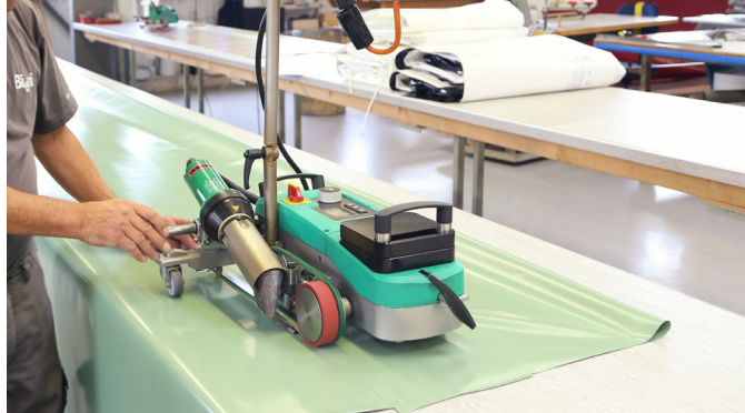
VARIANT T1 - zgrzewanie plandeki na stole
