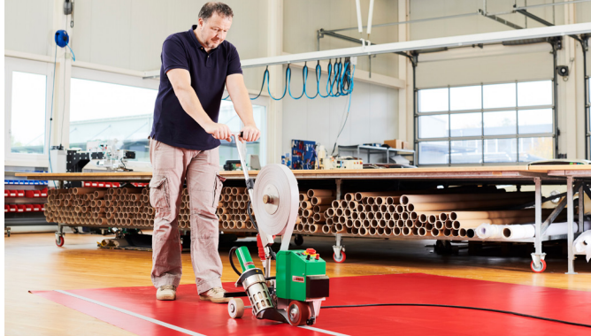
TAPEMAT - szybki automat do zgrzewania pasów wzmacniających na plankach i pokryciach technicznych.
