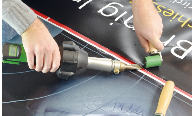
Zgrzewanie na zakładkę plandeki
