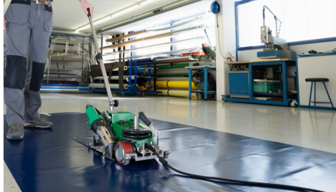
UNIPLAN 500 - zgrzewanie na podłodze
