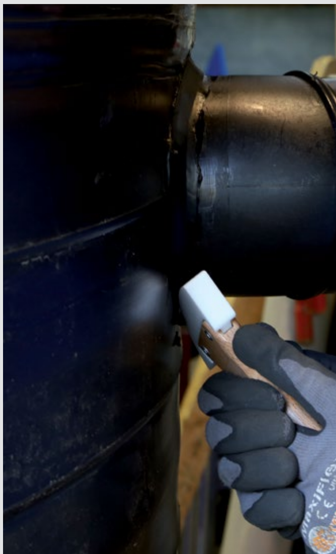
PLASTFIX zapewnia odpowiedni docisk spoiny.
