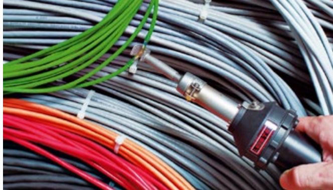
Obkurczanie otuliny za pomocą HOT JET S z reflektorem siatkowym
