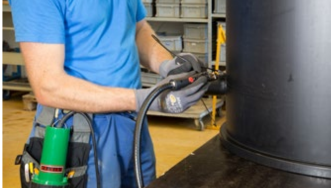
Spawanie zbiornika LABOR S z dmuchawą MINOR
