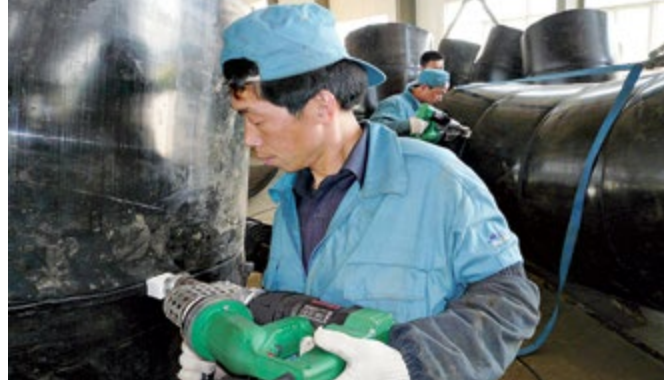
Spawanie zbiornika ekstruderem FUSION 2
