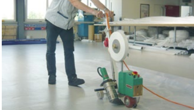
Wzmacnianie firanki pasami pod klamry napinające.
