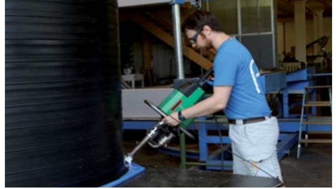
WELDPLAST S6 - ekstruder do zadań specjalnych.
