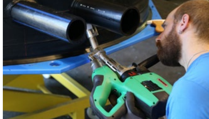
Spawanie z użyciem przedłużki kątowej 45 °
