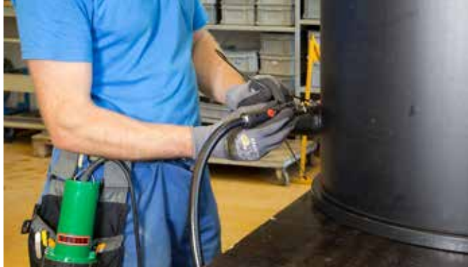
Spawanie zbiornika LABOR S z dmuchawą MINOR
