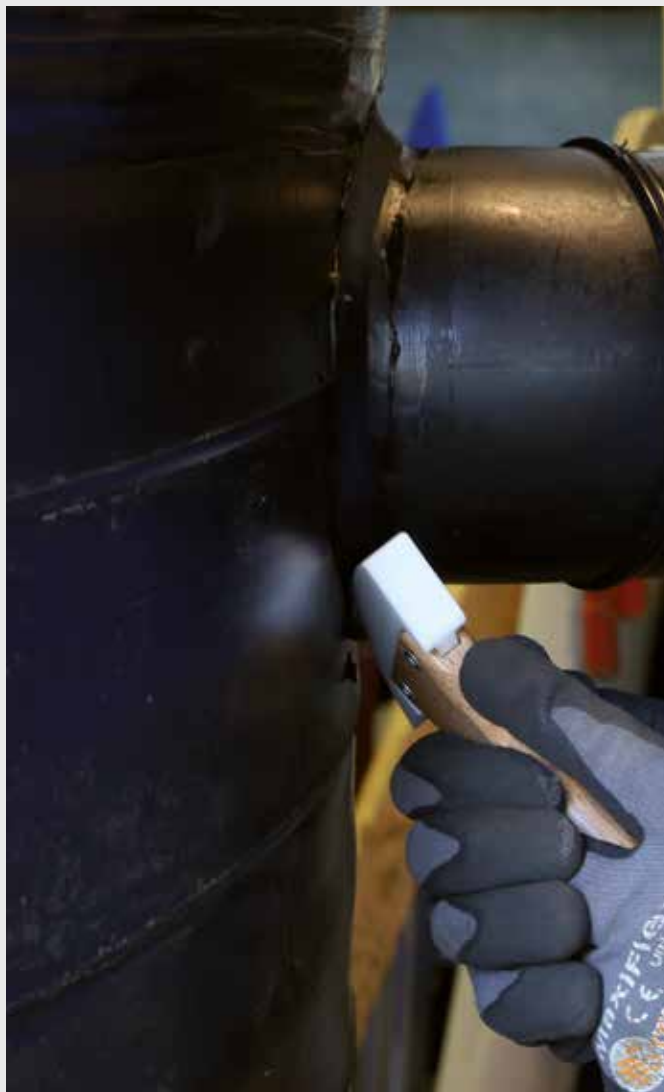
PLASTFIX zapewnia odpowiedni docisk spoiny.
