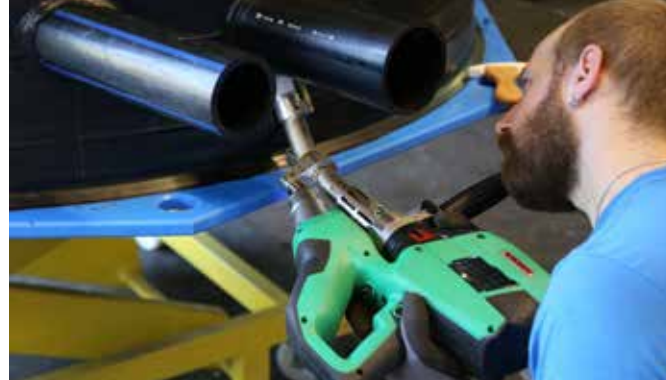
Spawanie z użyciem przedłużki kątowej 45 °
