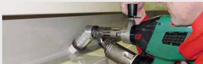
Wykorzystanie przedłużki kątowej 45° do spawania w trudno-dostępnych miejscach
