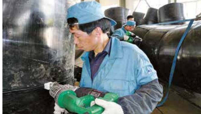
Spawanie zbiornika ekstruderem FUSION 2
