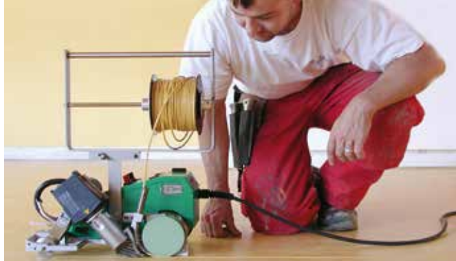
UNIFLOOR E z rozwijakiem podczas spawania linoleum.
