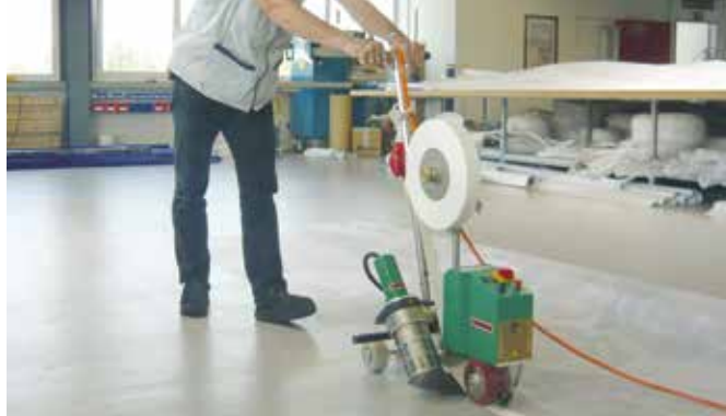
Wzmacnianie firanki pasami pod klamry napinające.
