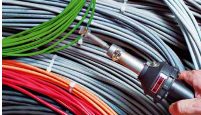
Obkurczanie otuliny za pomocą HOT JET S z reflektorem sitkowym
