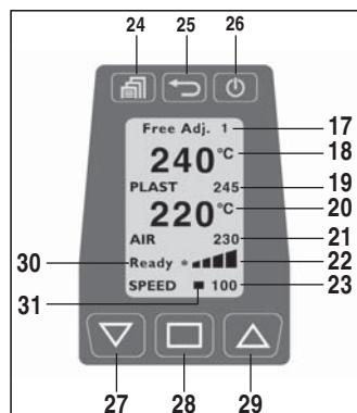
Wydajność produkcyjna jest zależna od stosowanego drutu spawalniczego. Jeżeli wydajność jest zbyt duża przy wartości na wyświetlaczu wydajności produkcyjnej «30» oraz ustawieniu potencjometru w pozycji „Minimum”, należy zastosować drut spawalniczy o mniejszej średnicy.
