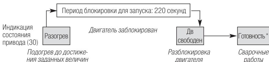
Непосредственно после включения **главного выключателя (1)** прибор нагревается до установленной в последний раз заданной температуры. Если заданная температура достигнута, счетчик индикатора состояния ведет счет от 220 секунд обратно до нуля. По окончании данного процесса пуска прибор готов к сварке (статус Готовность\*). Ручной экструдер достигает своей рабочей температуры прибл. в течение 5 минут.
