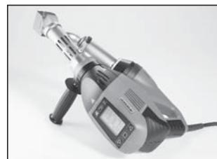
Při přerušení svařování vypněte pohon **vypínačem pohonu (2)**. Ruční extrudér s odpovídajícím způsobem nastavenou a utaženou rukojetí postavte dle obrázku na stabilní, žáruvzdorný podklad.
