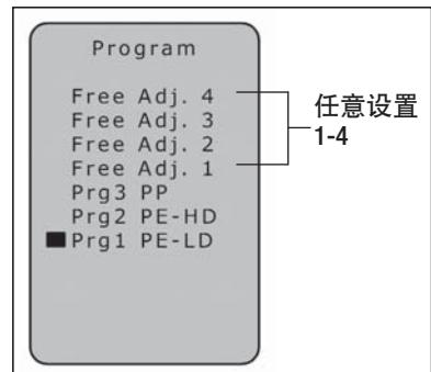
**程序 1 – 3** 设有相应的预设置参数，在焊接过程中可对这些参数进行调节。
