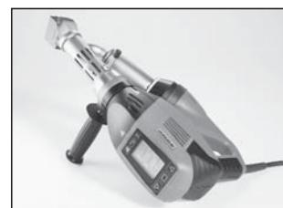
W przypadku przerwania prac spawalniczych napęd należy wyłączyć **włącznikiem/wyłącznikiem napędu (2)**. Ręczny ekstruder z odpowiednio ustawioną i dokręconą rączką postawić zgodnie z rysunkiem §na stabilnej, ogniodpornej spodstawie.
