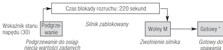
Bezpośrednio po włączeniu **wyłącznika głównego (1)** urządzenie rozgrzewa się do ostatnio ustawionej temperatury zadanej. Gdy osiągnięte zostaną temperatury zadane, licznik na wskaźniku stanu odlicza od 220 sekund do zera. Po zakończeniu procesu rozruchu urządzenie jest gotowe do spawania (Stan gotowy\*). Ekstruder ręczny osiąga swoją temperaturę roboczą po ok. 5 minutach.
