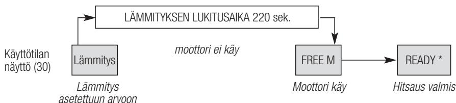
Käynistettäessä laite **pääkytkimestä (1)**, laite lämmittää itsensä edellisen käytön säädetyihin arvoihin. Kun arvot on saavutettu, näytössä oleva laskuri aloittaa laskun 220 sekunnista nollaan. Lämmitysjakson päätyttyä, laite on käyttövalmis ja näytössä oleva indikaattori ilmoittaa Ready=valmis. Laite on käyttövalmis noin 5 minutissa. Bei kurzzeitigem Netzunterbruch entfällt ein erneuter Startvorgang. Lyhyt sähkökatkos ei toista laitteen lämmitysjaksoprosessia uudestaan.
