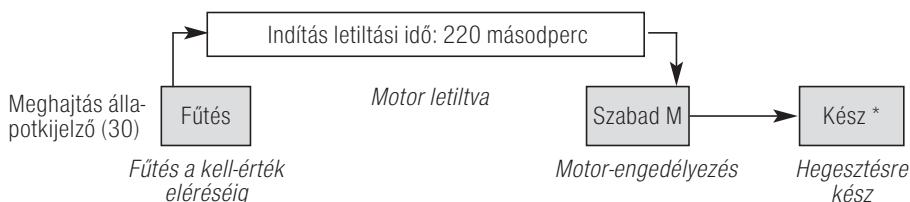
A berendezés a **főkapcsoló (1)** bekapcsolása után a legutóbb beállított kell-hőmérsékletre fűtődik fel. A kell-hőmérséklet elérése után a kijelzőn látható számláló 220 másodpercről nullára számol vissza. Az indítási folyamat befejezével a berendezés készen áll a hegesztésre (Kész \* állapot). A kézi extruder üzemi hőmérsékletét kb. 5 perc után éri el.
