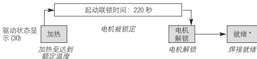
在总开关 (1) 打开后，设备直接加热至上次设定的额定温度。在达到额定温度时，状态显示中的一个计数器从 220 秒倒数至 0。启动过程结束后，设备进入焊接就绪状态（就绪状态\*）。手动挤出焊接机在约 5 分钟后达到其运行温度。
