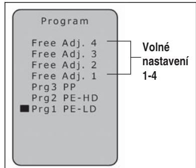
**Programy 1 – 3** jsou opatřeny příslušnými přednastavenými parametry, které lze během svařování přizpůsobit.
