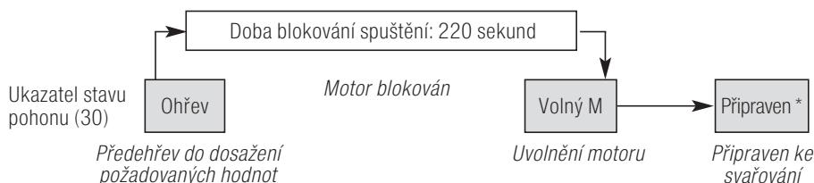
Přístroj se zahřívá ihned po zapnutí **hlavního vypínače (1)** až k dosažení naposledy nastavených požadovaných teplot. Jsou-li dosaženy požadované teploty, odpočítává počítač v ukazateli stavu z 220 sekund zpět na nulu. Po proběhnutí tohoto startovacího procesu je přístroj připraven ke svařování (stav Bereit\*). Ruční extrudér dosáhne své provozní teploty cca za 5 minut.
