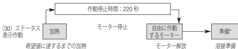
機器は**メインスイッチ (1)**のスイッチをオンにした後に、設定した希望温度になるまで熱します。希望温度に達したら、ステータス表示内のカウンターが220秒をカウントした時に、0に戻ります。この開始手順が完了したら、機器の溶接準備が整います（準備ステータス\*）。Hand-Extruder は約5分で作動温度に達します。
