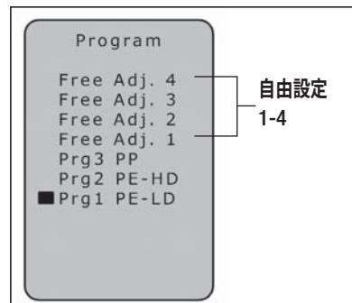
プログラム1から3は予め設定されたパラメーターで供され、それは溶接手順の中で適応するように調節できます。適応設定は保存されません！
