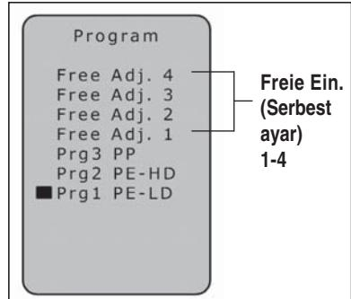
**1'den 3'e kadar olan programlar**, kaynaklama işlemi sırasında uyarlanabilen ön ayarlı parametrelere sahiptir. Yapılan uyarlamalar kaydedilmez!
