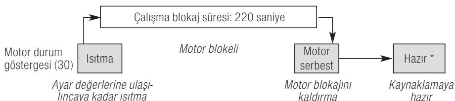
Cihaz, ana **şalter (1)** açıldıkten sonra, son olarak ayarlanmış olan ayar sıcaklığına doğrudan ısınmaya başlar. Ayar sıcaklığına ulaşıldığında, durum göstergesindeki bir sayıç 220 saniyeden geriye doğru sıfıra kadar saymaya başlar. Bu başlatma işlemi geçiktelen sonra cihaz kaynak yapmaya hazır (Durum: Hazır\*). El tipi ekstruder, çalışma sıcaklığına yaklaşık 5 dakikada ulaşır.
