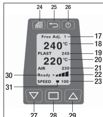
Çıkış miktarı, kullanılan kaynak telinin kalınlığına bağlıdır. Ekstruderdeki çıkış, çıkış göstergesi «30» ve potansiyometre konumu «Minimum» olmasına rağmen çok büyük olduğunda, bir küçük boy kaynak teli kalınlığına geçilmelidir.
