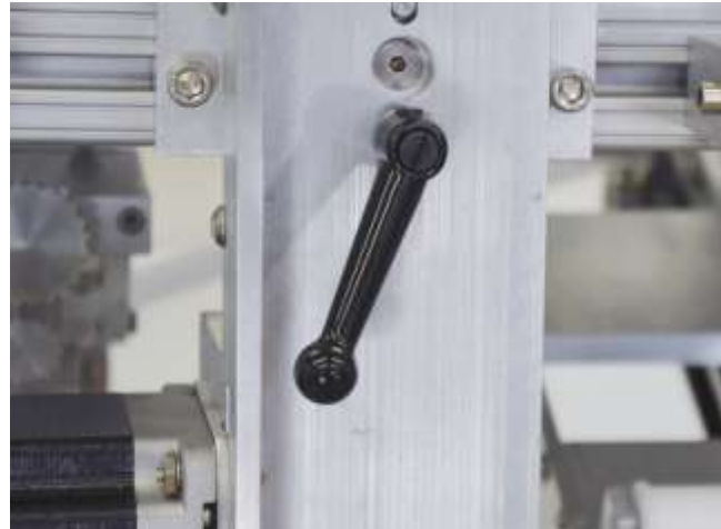
Abb. 34 - Montierter Kipphebel
