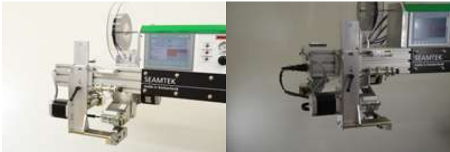
Abb. 32 Quick Arm in Schweissposition Abb. 33 - Montierter Quick Arm
