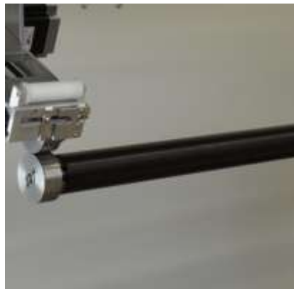
Abb. 44 – „Side Arm“ (Seitenarm), Ausbau und Wechsel der Rolleneinheit
