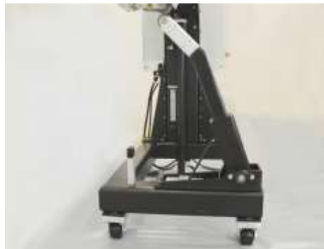
Abb. 27 Fussgestell in Schweissposition
