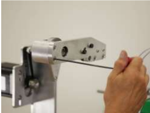
Abb. 45 - Hinterer Keil entfernt
