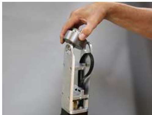
Abb. 40 - Riemenspannvorrichtung
