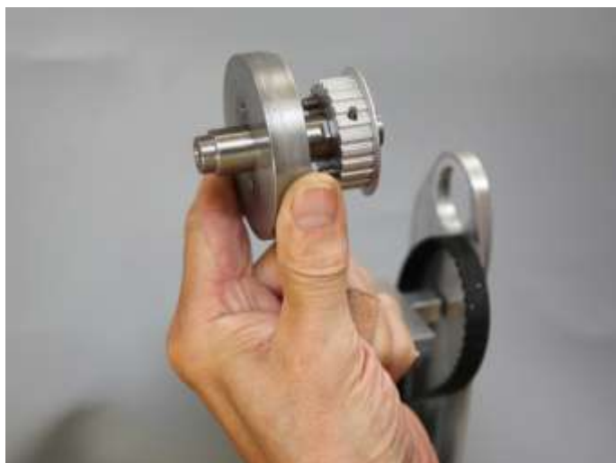
Abb. 42 - Rolle wechseln
