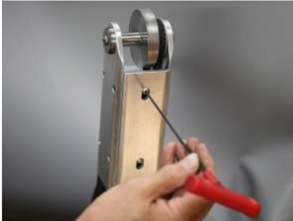
Abb. 44 - Anbringen der Seitenplatten-Befestigungen und Montage des Fussgestellkopfs auf der Fussgestell-Abdeckungen anbringen. – Jetzt kann wieder geschweisst werden.
