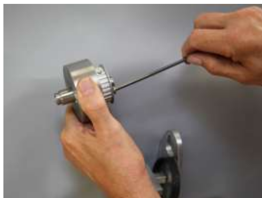
Abb. 40 - Riemenspannvorrichtung
