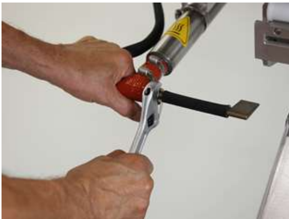
Abb. 48 - Wechsel der Düsen
